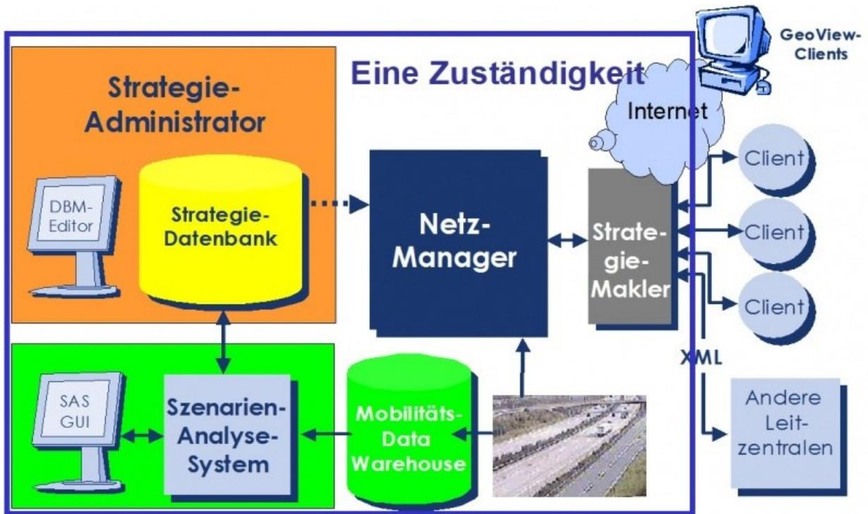
Bild 9: Komponenten des ISM (Hessen Mobil)
